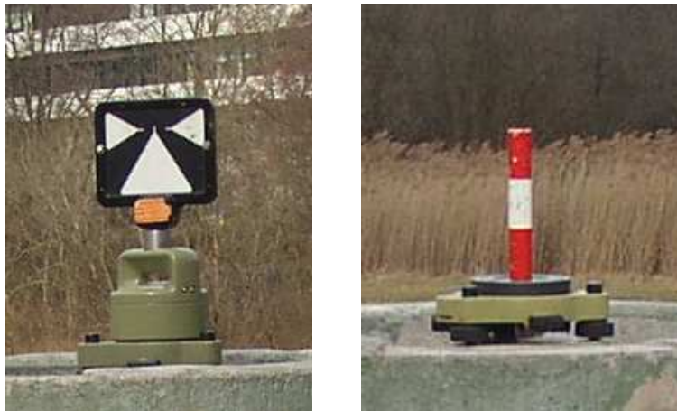
Abbildung 4.3: Zieltafel und Zielrohr
